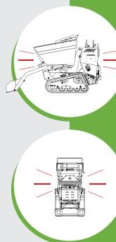
Les **CAPTEURS** avertissent l'utilisateur, en cas d'inclinaison longitudinale supérieure à 30% (17°) et d'inclinaison transversale supérieure à 15% (8,5°), au moyen d'un signal sonore.
