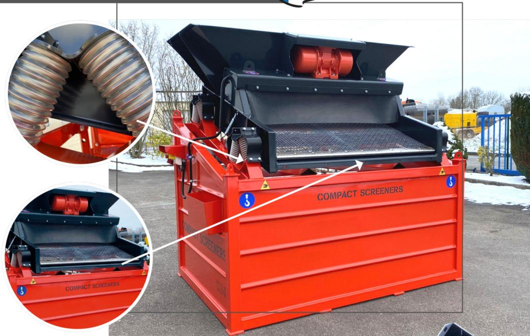
**Crible vibrant : 2 fractions à un Tamis**
