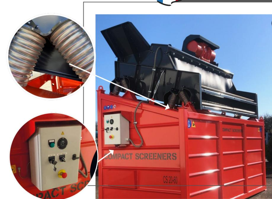
**Crible vibrant : 2 fractions à deux Tamis**
